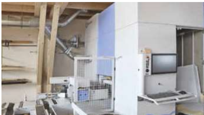
/ Die erzeugten Späne der CNC-gesteuerten 5-Achs-Abbundanlage sind schuld, dass für Hillmann eine komplett neue Absauganlage konzipiert werden musste.
