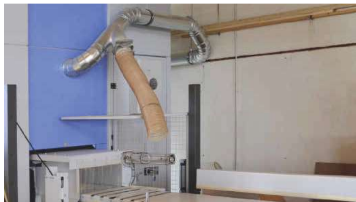
/ Weisheit aus der täglichen Abbundpraxis: Ein nachträglich installierter Luftschlauch saugt die auf dem Bauteil liegenden Späne aus der Vorbearbeitung ab.
