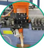
Oberliegendes, auswechselbares Schnellheizbecken mit Auslaufvorrichtung zur Verarbeitung von PU-Kleber
