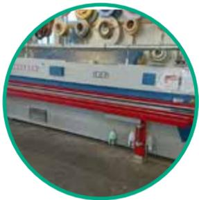
Fügen – Anleimen – Kappen – Bündigfräsen – Radiusfräsen – Eckenrunden – 2 Radiusziehklingen – Flächenziehklinge - Gleitmittelsprühen – Reinigungsset – Combi-Melt Servicestation – für PU-Verarbeitung
